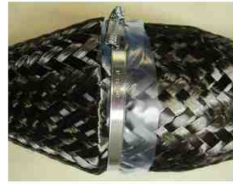
〈그림. 열가소성 mandrel 브레이딩과 PA6 foil를 이용한 fiber fixation〉
