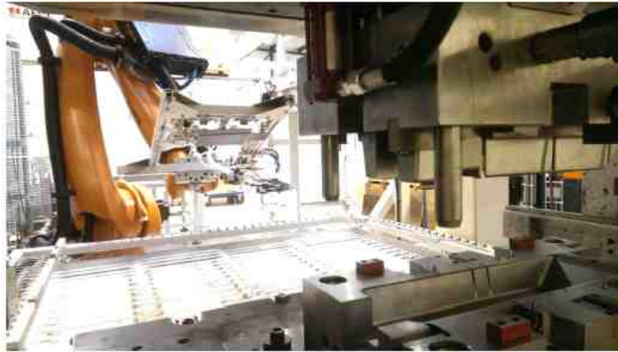
〈그림. thermoforming과 overmoulding press을 위한 자동화 이송시스템〉
