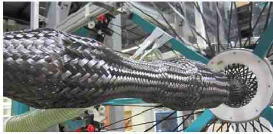
〈그림. 열가소성 mandrel 브레이딩과 PA6 foil를 이용한 fiber fixation〉
