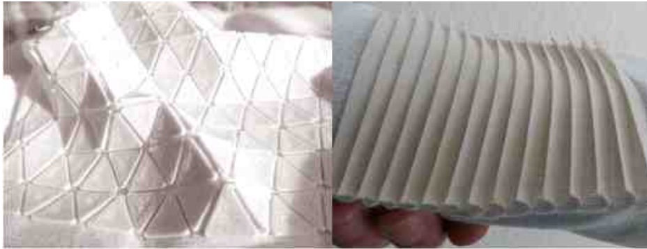
〈 면 직물 위에 PLA soft 소재를 사용하여 FDM 3D 프린팅을 한 구조물 〉
