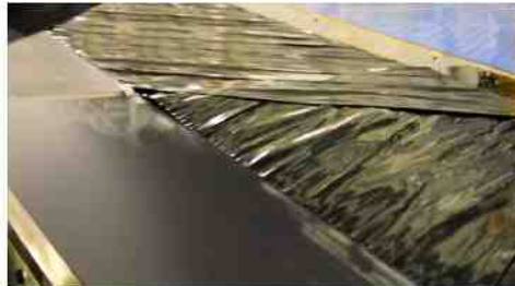
〈그림. PA6 수지가 함침된 탄소섬유 시트 (0/45/135) 폭 600mm〉
