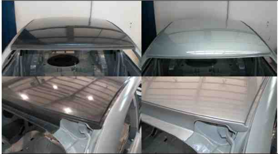
〈그림. AUDI A1에 적용한 RST process CFRP-roof〉
