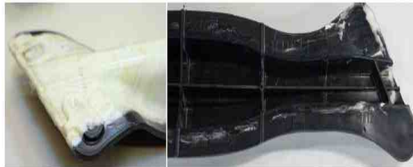
〈그림. 인젝션 몰딩으로 성형된 rib 구조부품 성형〉
