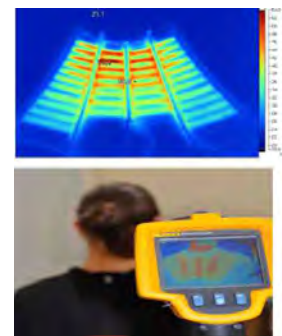
〈 전도성 프린팅 기술을 이용한 Sensor array(左)와 발열 셔츠(右) 〉
